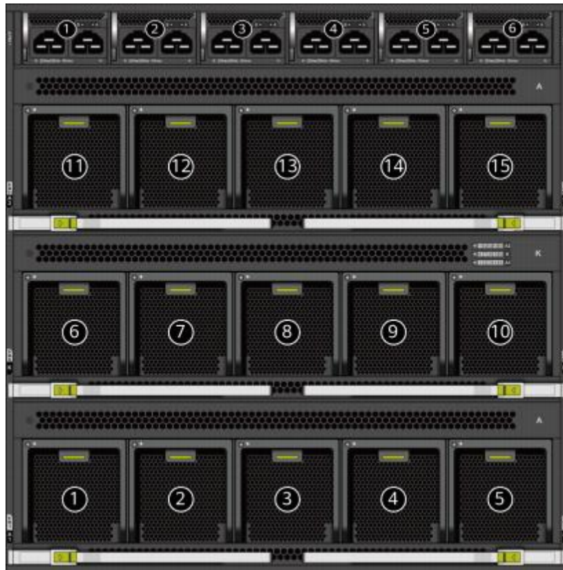
图 6-5 风扇和 PSU 电源模块位置示意图
