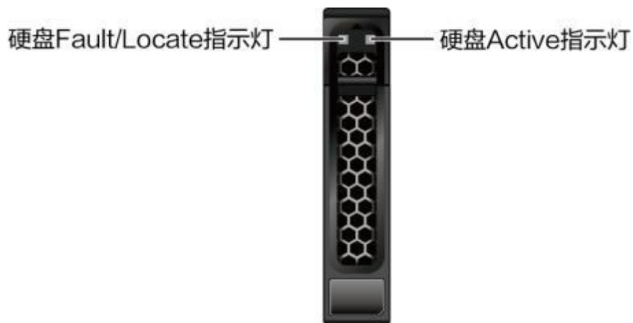
图 6-40 SATA 硬盘指示灯示意图
